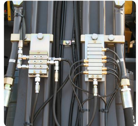
Progressivverteiler VPM-3 als Hauptverteiler und VPKM-8 als Unterverteiler
