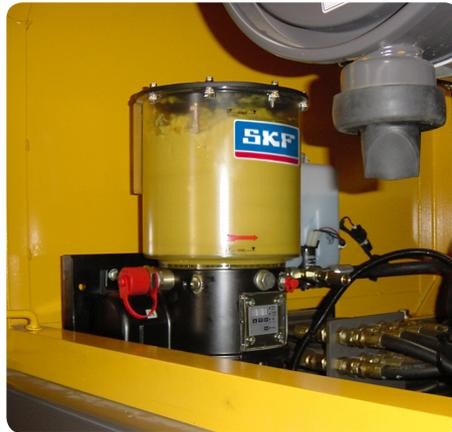
Kolbenpumpe KFGS mit 6 kg-Fettbehälter
