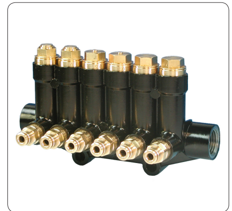
Kolbenverteiler, Baureihe VKS06 Dosierung 0,1 bis 0,4 cm 3 mit Universal-Steckverbinder
