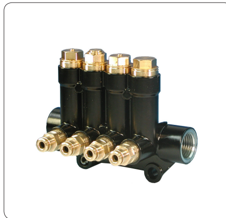
Kolbenverteiler, Baureihe VKS04 Dosierung 0,1 bis 0,4 cm 3 mit Universal-Steckverbinder
